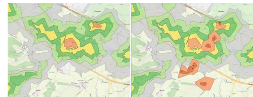
Abbildung 7 Darstellung der ÖV Güteklassen (höchste Güteklasse A, sehr geringe Güte G) am Beispiel der Pilotregion im Projekt RIAMO, links ohne On-Demand Verkehr, rechts mit der verbesserten ÖV Güte durch den automatisierten On-Demand Verkehr
