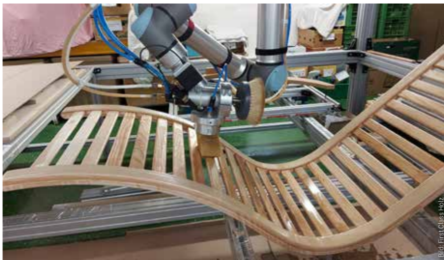
Im Kooperationsprojekt „RoboCoat“ wurden monotone Arbeiten wie Verfugen und Ölen von Bauteilen automatisiert.
