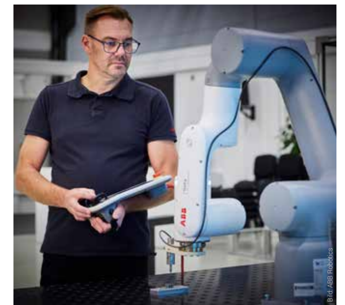
Autonomous Versatile Robotics (AVR) steht für eine neue Generation von Robotern, die nicht mehr festen Programmen folgen, sondern unmittelbar auf gezeigte oder gesprochene Anweisungen reagieren.
